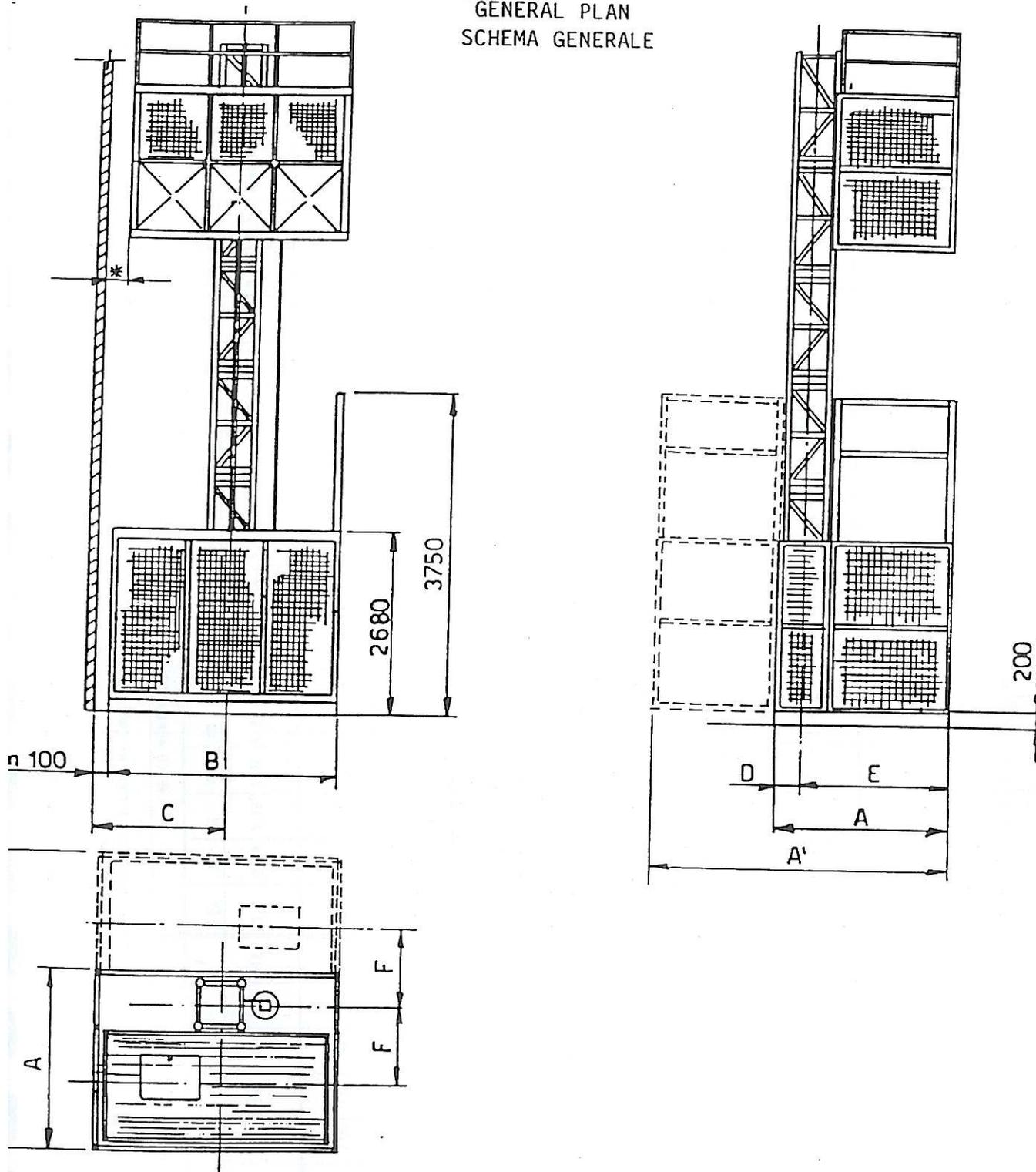
• distanze inferiori a 0,70 m si devono prevedere dei pannelli di protezione, da 0,70 m, lateralmente alle porte di piano.
